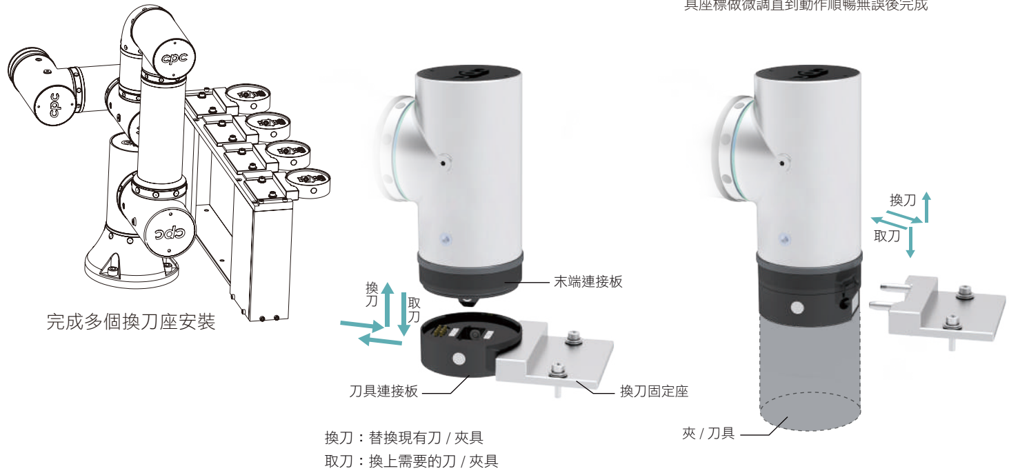
設定換刀機構與機械手臂座標之對正
