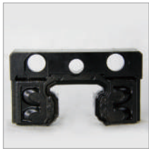
密封プレート破損無し
