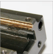
潤滑油の乾燥残留物、上部給油タンクは破損状態
