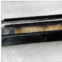
潤滑油の乾燥残留物、下部給油タンクは破損状態
