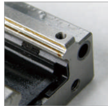
上部給油パッドは正常に設置、正常に給油、レール溝も正常
